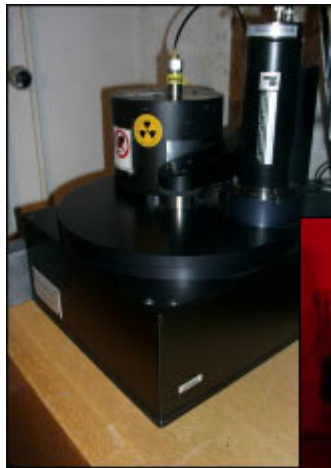
Lumineszenzmessgerät, Probenaufbereitung & Messung im Rotlichtlabor
