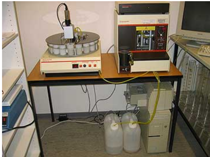
Sedigraph zur Messung der Korngrößen
