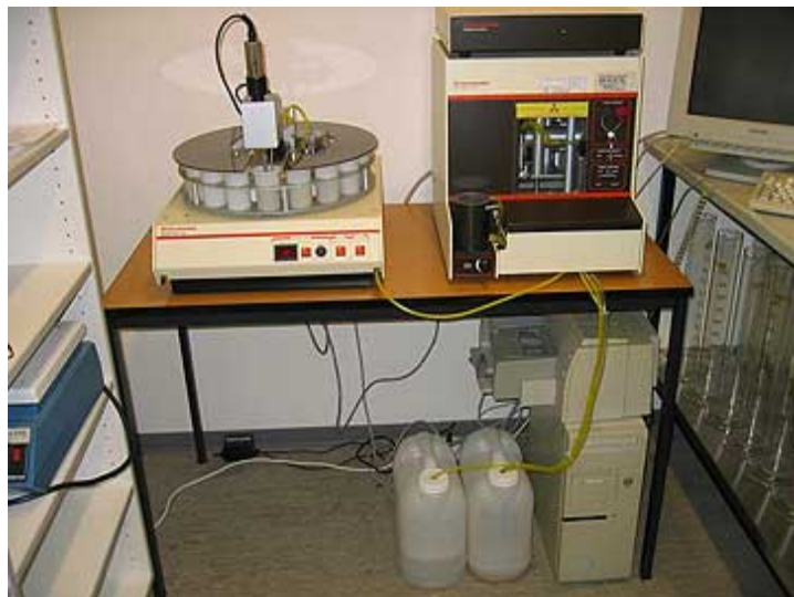
Sedigraph zur Messung der Korngrößen
